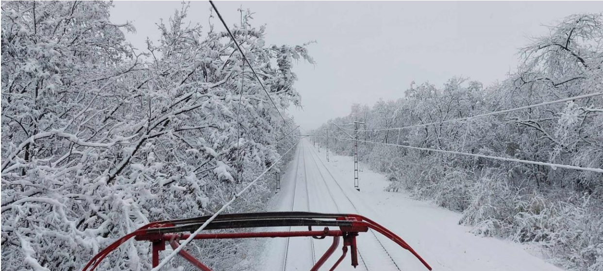
2. kép: Emőd és Mezőkeresztes-Mezőnyárad állomások között a rendkívüli időjárás miatt az úrszelvénybe belógó faágak az 5019 sz. vonat áramszedőtörését okozták 2024.11.22.
