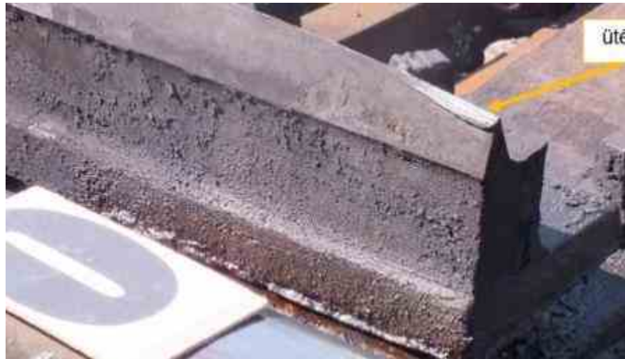
6. ábra: csúcssín hegyén az ütésnyom
