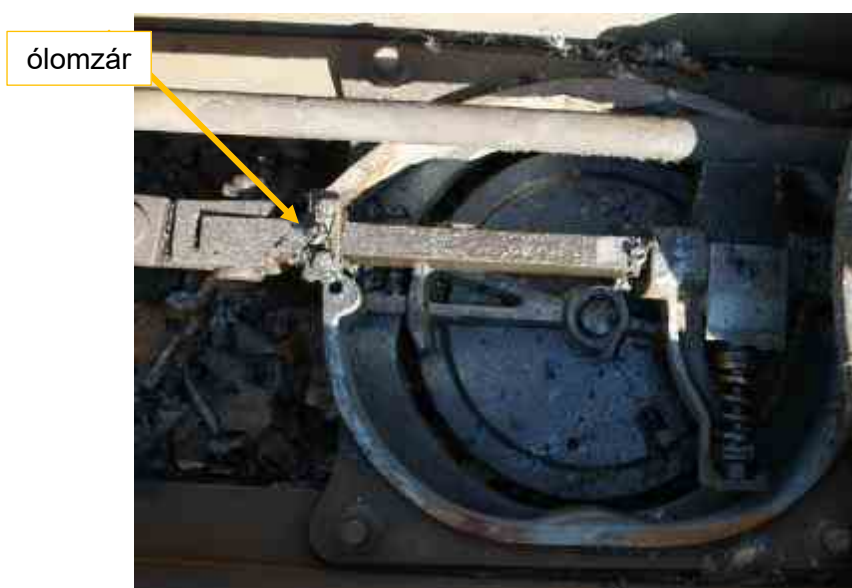
5. ábra: a váltóállító dob
