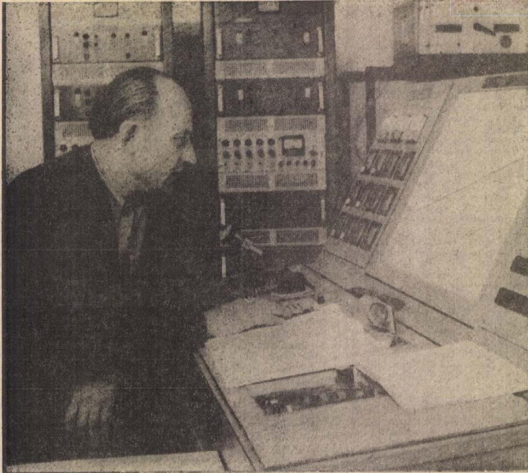
A Nógrádi Szénbányák szorospataki aknaüzemében diszpécserközpont segíti a munkát. A központ állandó kapcsolatot tart a szénkitermelő és szállító egységgel, valamint a bányabeli munkahelyekkel. Így könnyebben és gyorsabban kerülhet felszínre a fekete „gyémánt”. Képünkön: Nagy Károly diszpécser a korszerű kezelőpultnál. — bábel felv. —
